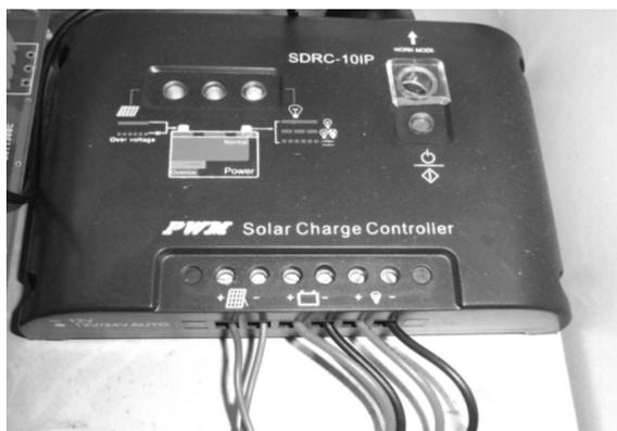
图 4 电源控制器指示状态
